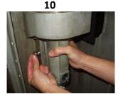
Svitare rspt. avvitare con la mano SINISTRA la vite del collettore succhi tenendo contemporaneamente con la\_mano DESTRA il collettore stesso.
