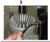
Smollare rspt. stringere tramite leva entrambi i bulloni a vite della coppa inferiore e controllare prima della messa in moto dello spremiagrumi.
